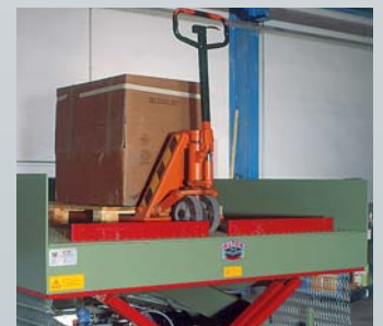
Mechanische Abfallsicherung, verhindert das Abstürzen der Güter.
